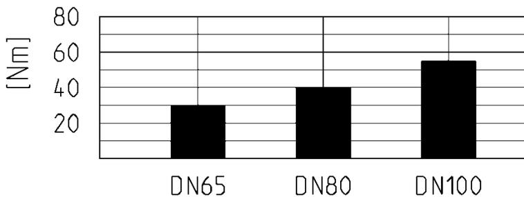
Anzugsdrehmoment der Schrauben bei Flanschverbindungen
