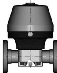
2/2-Wege-Membranventil mit pneumatischem Stellantrieb und optischer Stellungsanzeige
