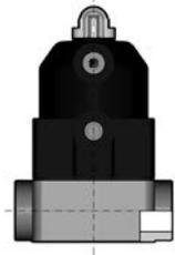
2/2-Wege-Membranventil mit pneumatischem Stellantrieb und optischer Stellungsanzeige
