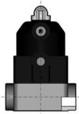
2/2-Wege-Membranventil mit pneumatischem Stellantrieb und optischer Stellungsanzeige
