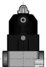
2/2-Wege-Membranventil mit pneumatischem Stellantrieb und optischer Stellungsanzeige
