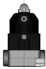
2/2-Wege-Membranventil mit pneumatischem Stellantrieb und optischer Stellungsanzeige
