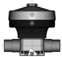
2/2-Wege-Membranventil mit pneumatischem Stellantrieb und optischer Stellungsanzeige
