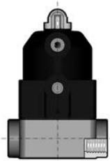
2/2-Wege-Membranventil mit pneumatischem Stellantrieb und optischer Stellungsanzeige
