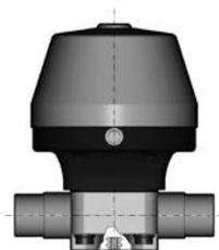
2/2-Wege-Membranventil mit pneumatischem Stellantrieb und optischer Stellungsanzeige
