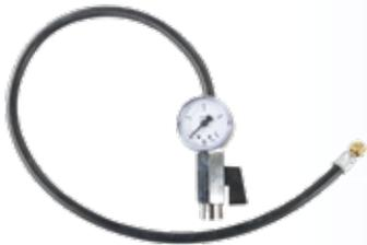
Bestehend aus einem 60cm langen, flexiblen Füllschlauch. Einerseits mit Überwurfmutter Vg8 für das Prüfventil am Ausdehnungsgefäß, andererseits mit Kugelhahn mit 7/16-28 UNEF Gewinde für die Nachfüllflasche, sowie einem Prüfmanometer Durchmesser 40mm, Klasse 1,6.
