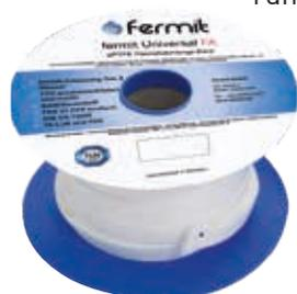
Der besondere Herstellungsprozess für das zu 100 % aus expandiertem Polytetrafluorethylen (ePTFE) gefertigte Band sorgt für ein äußerst **zuverlässiges Dichtverhalten an Flanschen, Boilern, Pumpen, Rohrleitungen, Wärmetauschern, Lüftungs- und Klimaanlage**n und mehr.
